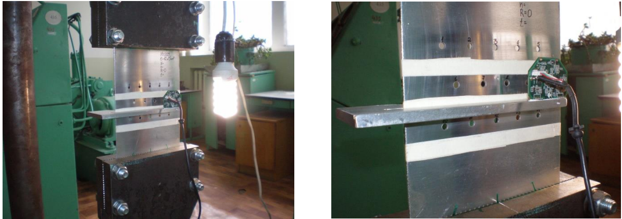
Рис. 2.8. Установка цифрової камери Logitech QuickCam E3500 на зразку
