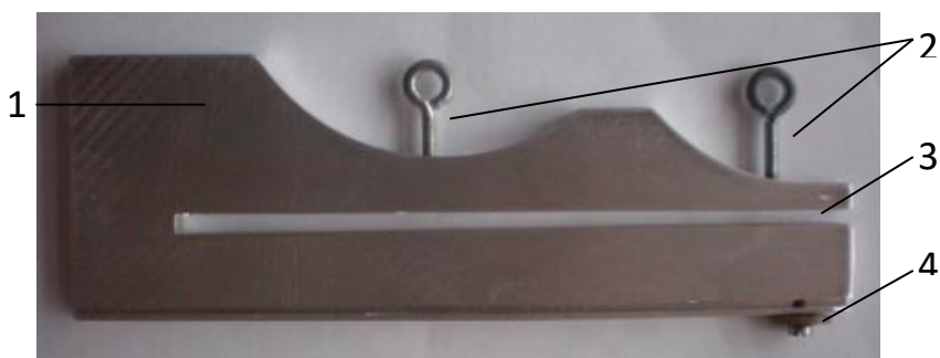
Рис. 2.7. Штатив для кріплення камери на зразку:
