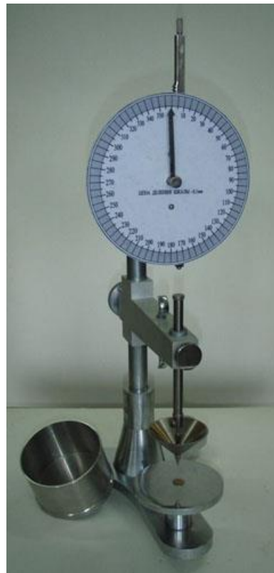
Рисунок 2.8 – Прилад ПН-1ЖВ для вимірювання пенетрації пластичних мастильних матеріалів
