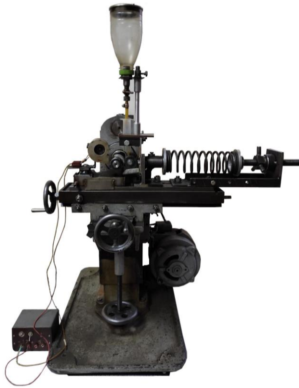
Рисунок 2.1 – Загальний вид установки ПТ-4Ц для дослідження триботехнічних характеристик пари тертя
