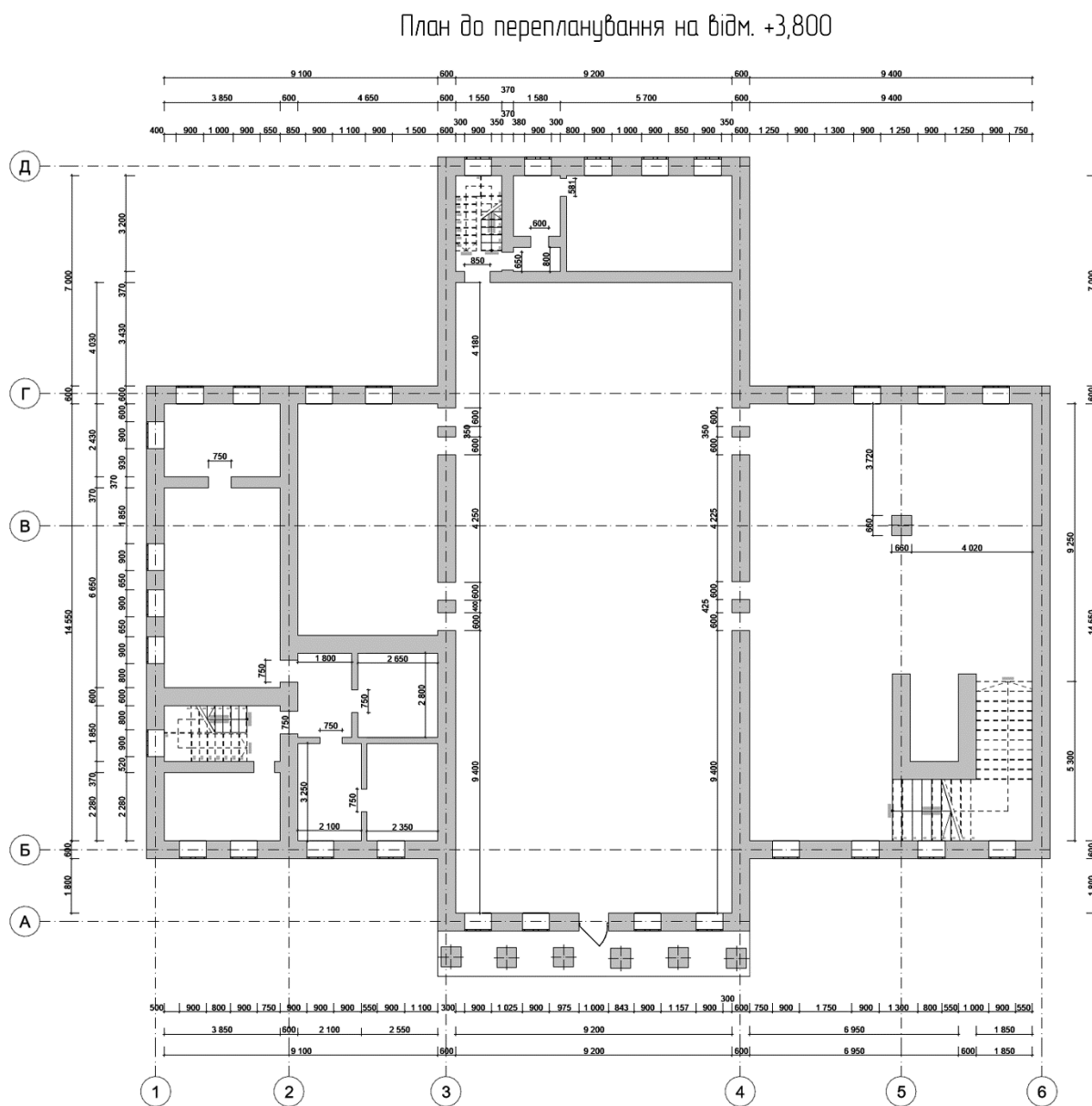
Рис.3.4. Вихідний план 2-го поверху.
