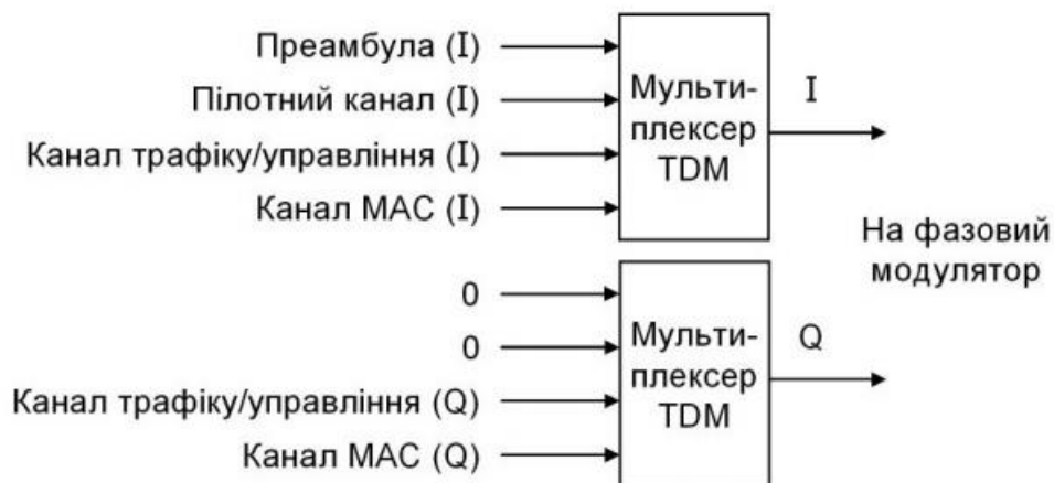
Рис. 3.2. Мультиплексування прямих каналів
