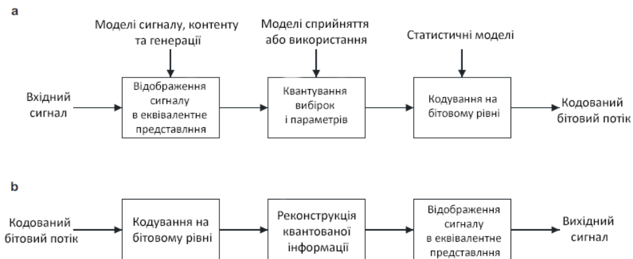
Рис. 1.2. Основний принцип системи кодування мультимедійних сигналів: а кодер, б декодер
