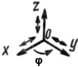
Рис. 6.4. Напрямки вимірювань чотири-координатно-вимірювальної машини
