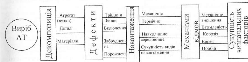
Рис. 2.4. Структурна схема аналізу механізму відмови виробу АТ
