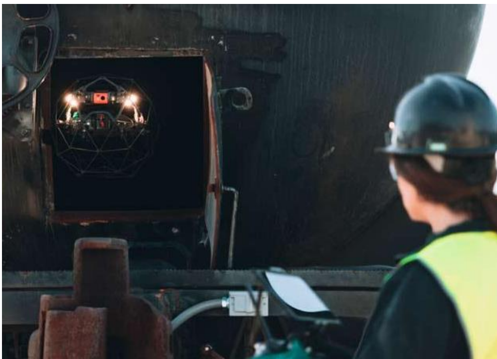
Рис. 3.5. Elios 2 під час вимірювання металу на виявлення поверхневих і внутрішніх недоліків
