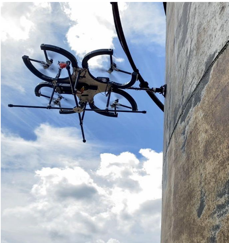
Рис. 2.2. Дрон Skygauge виконує контроль у небезпечних зонах
