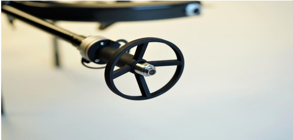
Рис. 2.3. Дрон Skygauge із встановленим P-C перетворювачем D790-SM Olympus
