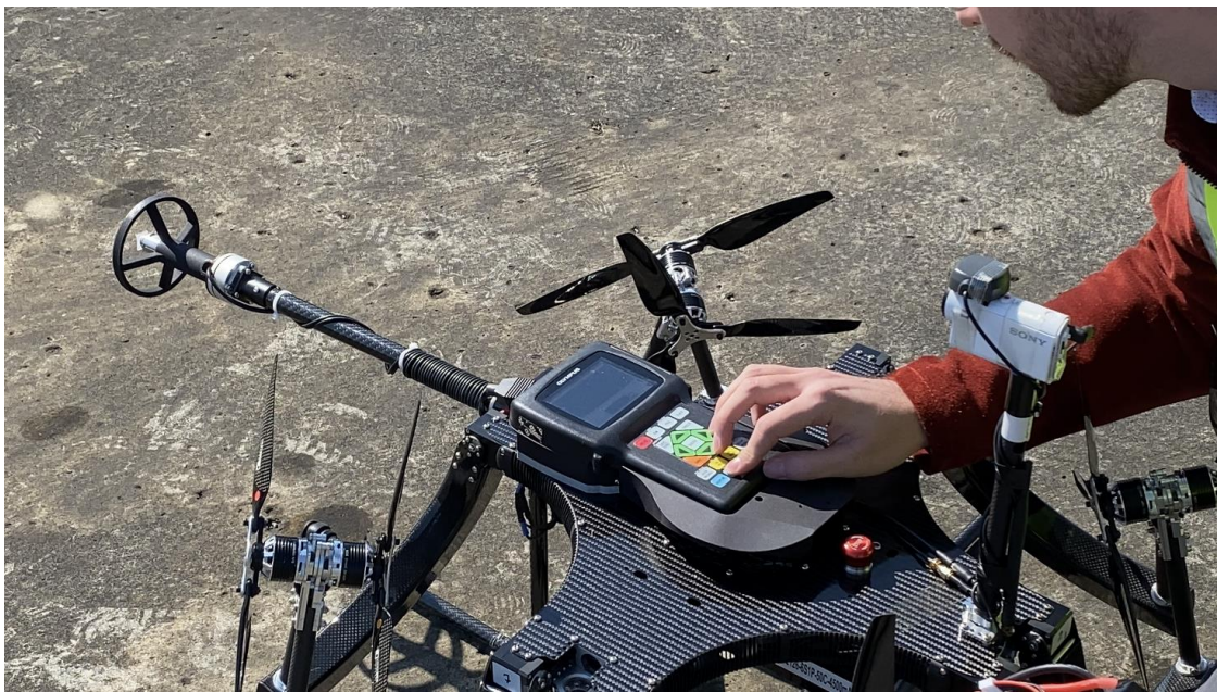
Рис. 2.1. Підготовка ультразвукового товщиноміра 38DL PLUS до польоту на дроні Skygauge
