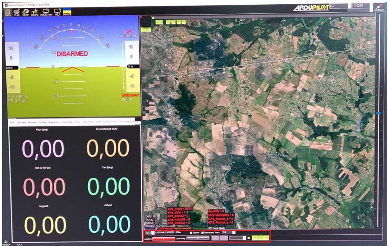
Рисунок 4.3 - Spoofing/Jamming indicator в програмному забезпеченні MissionPlanner
