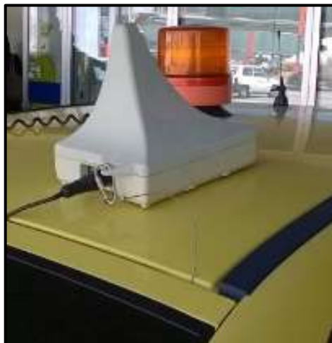
Рис. 1.11. Антена транспондера, яка встановлена на даху транспортного засобу для його ідентифікації на робочій площі аеродрому [41]
