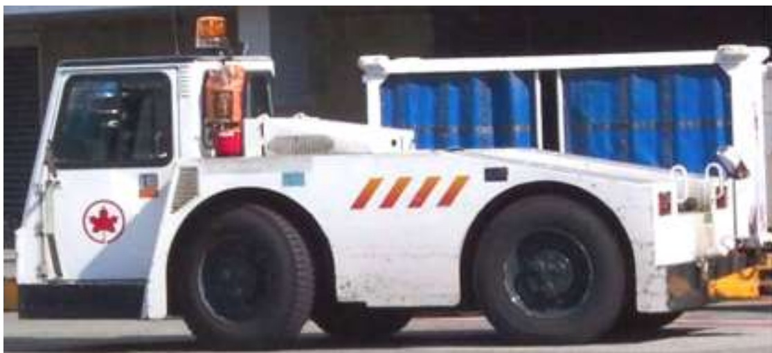
Рис. 1.7. Приклад встановлення пробліскового вогню на спецмашині [33]
