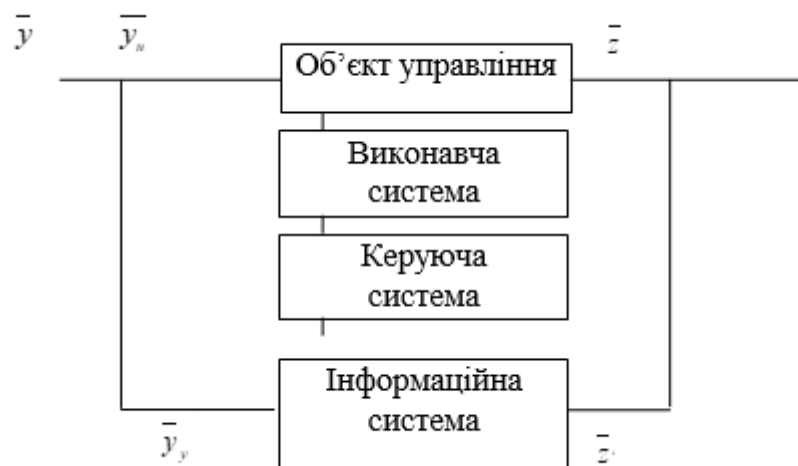
Рис. 1.1. Складна система управління процесами візуалізації за допомогою засобів великого модульного екрана
