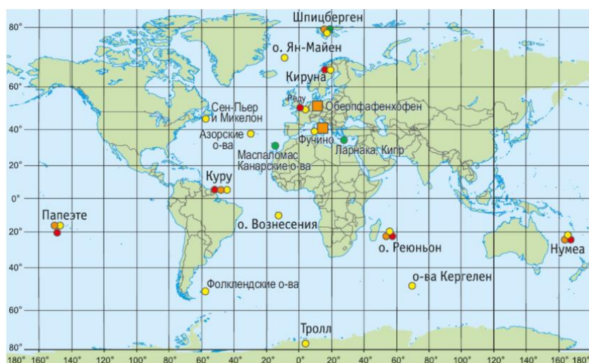
Рис. 2.3 Наземна інфраструктура супутникової навігаційної системи Галілео
