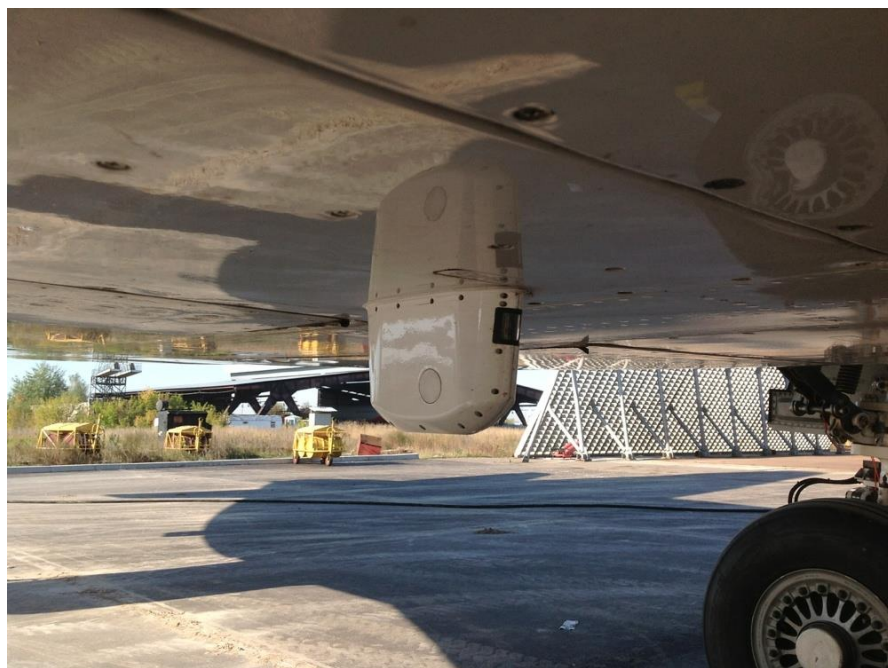
Рис.1.5 Зображення камери фірми Securaplane знизу фюзеляжу
