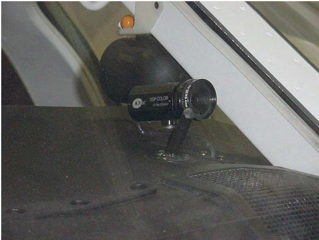
Рис.1.3. Відеокамера FD600CAM-2 вмонтована в кабіні екіпажу літака бізнес класу Сесна Сайтейшн ІІ (Cessna Citation ІІ)
