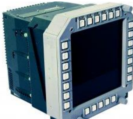
Рис.2.3. Багатфункціональний кольоровий індикатор МФЦИ
