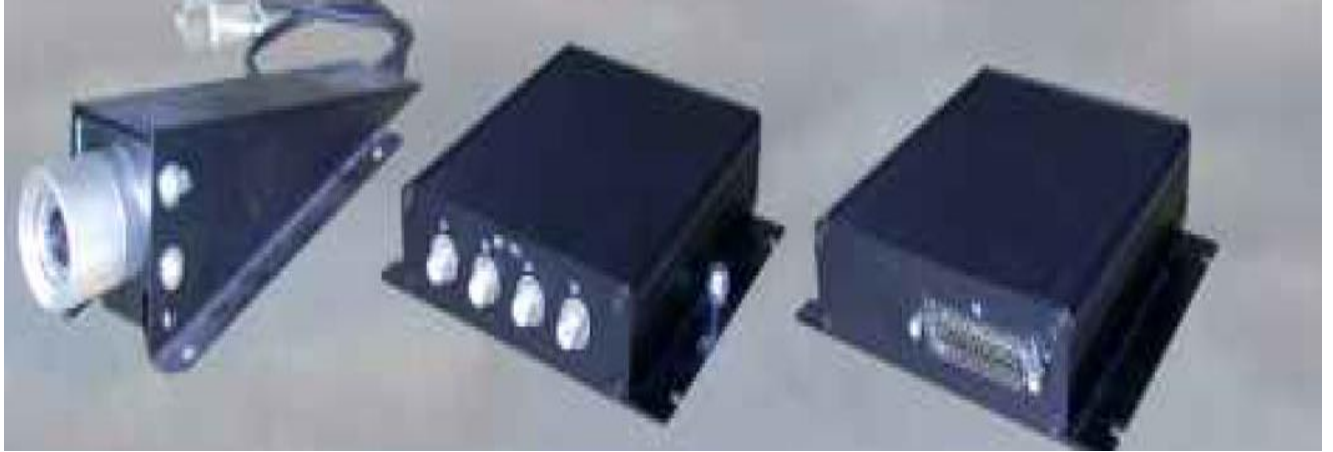
Рис.1.2. Склад системи: камера телевізійна КТ-200; відеорозділювач ВР-100; комутатор відеоканалів ВК-101.
