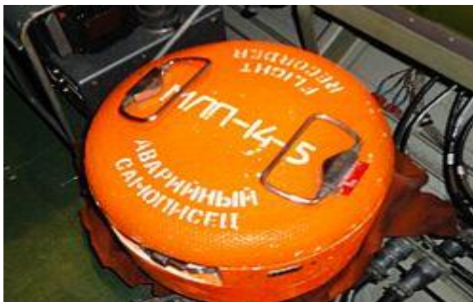
Рис.1.15. Стрічкопротяжний механізм МЛП-14-5 системи МСРП-64
