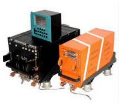
Рис.1.18. Бортовий пристрій реєстрації БУР-92А
