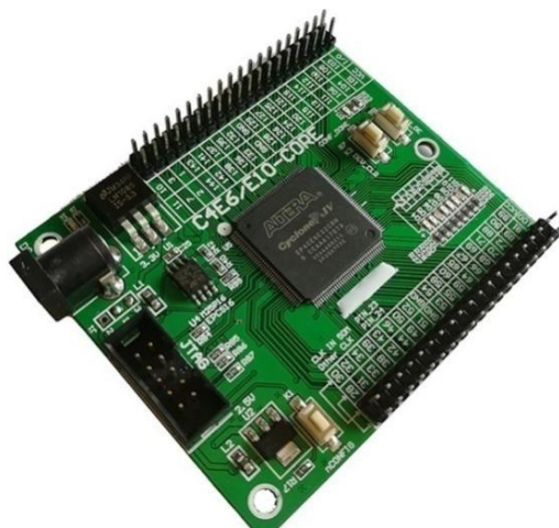
Рис. 1.7. Зовнішній вигляд ПЛІС ALTERA CYCLONE IV EP4CE6E22C8N
