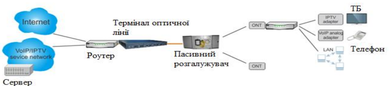
Рис. 1.1. Підключення до Інтернету із голосом та відео у формах IPTV/VoIP
