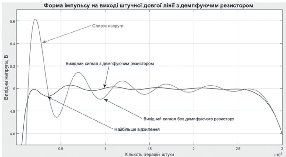
Рис. 3.4. Вершина імпульсу на виході штучної довгої лінії з демпфувальним резистором 1,7 R_L та ємністю першого каскаду 1,2 C у збільшеному масштабі
