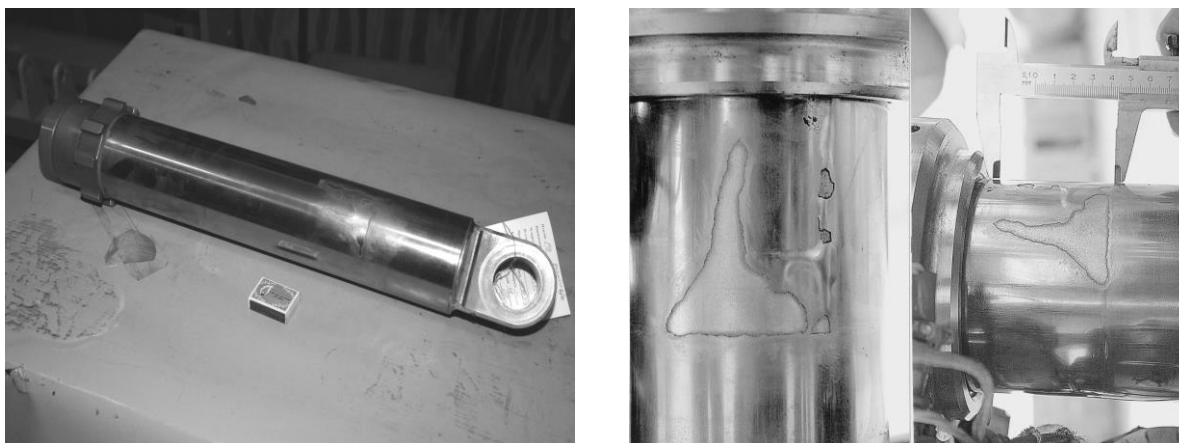
Рисунок 1.4 - Передній шток шасі літака Ан-148, пошкоджений фреттинг-корозією, виготовлений зі сплаву ВТ-22
