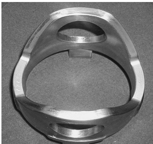
Рисунок 1.3 - Захоплення замку шасі літака Ан-148, пошкодженого фреттинг-корозією, виготовленого із сплаву ВТ-22
