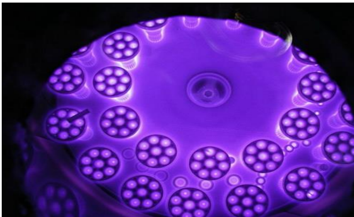
Рисунок 1.7 - Деталі при нагріванні під час азотування
