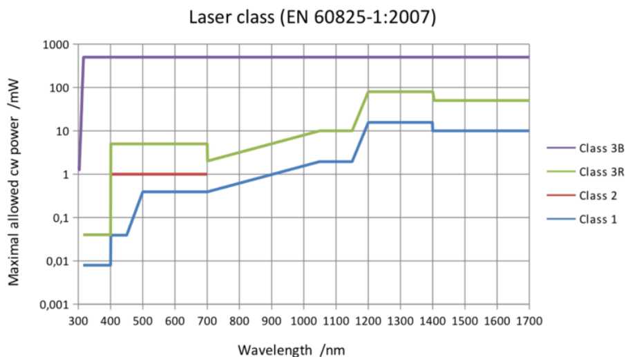
Рис.5.4. Максимально допустима безперервна потужність для лазерів класів 1, 2, 3R і 3B відповідно до стандарту EN 60825-1: 2007.
