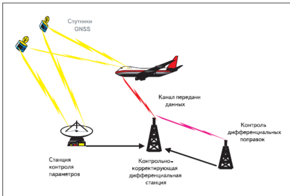
Рис. 3.1. Принцип функціонування GBAS.
