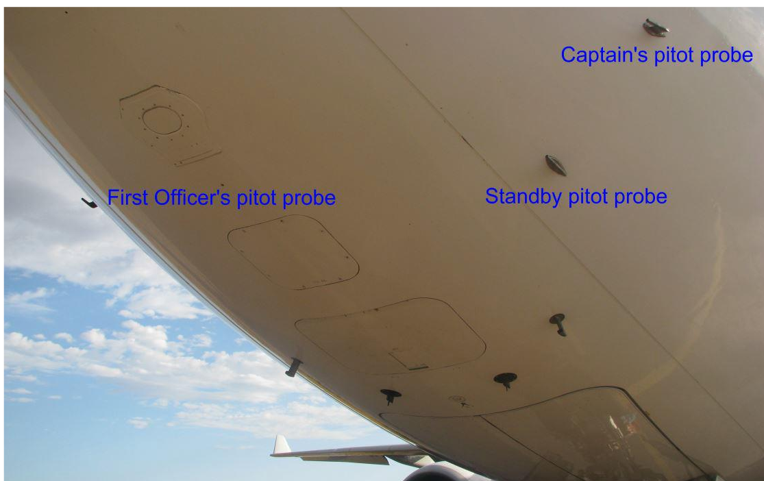
Рис.2.5. Розташування трубок Піто літака Airbus A320.
