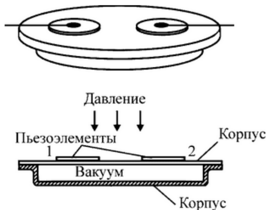
Рис. 3.15. Принципова схема частотно-мембранного датчика тиску.
