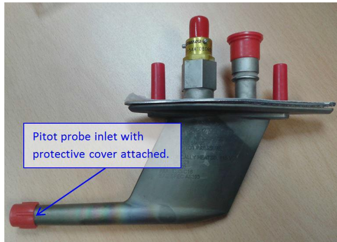
Рис.2.4. Зонд (трубка) Піто
