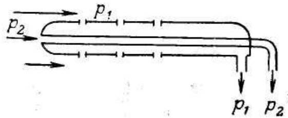
Рис. 1.4. Принципова схема приймача повітряного тиску
