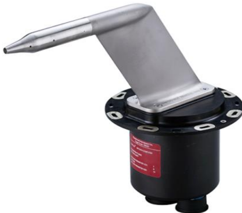
Рис. 4.8. Приймач повітряного тиску «Smart Probe Air Data System»
