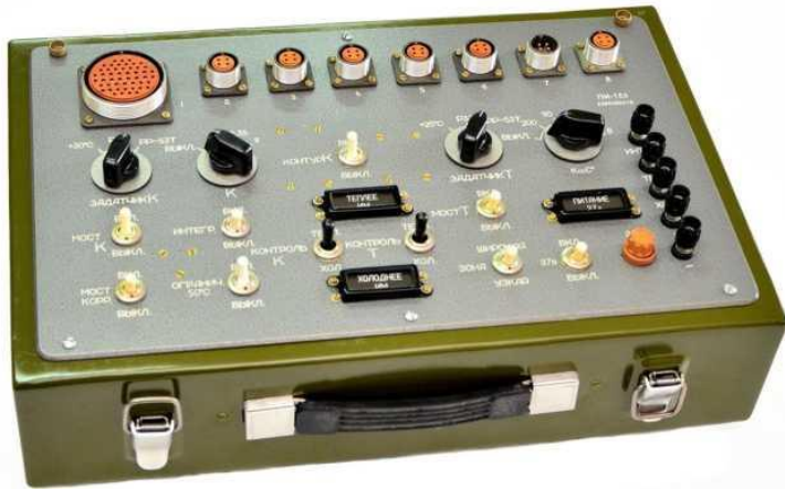
Рис.2.6. Пульт випробувальний ПІІ-153 (показаний без верхньої кришки).
