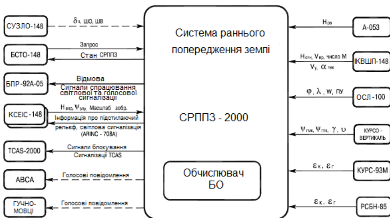
Рис.2.1 Схема зв'язків СРППЗ із системами літака Ан-148
