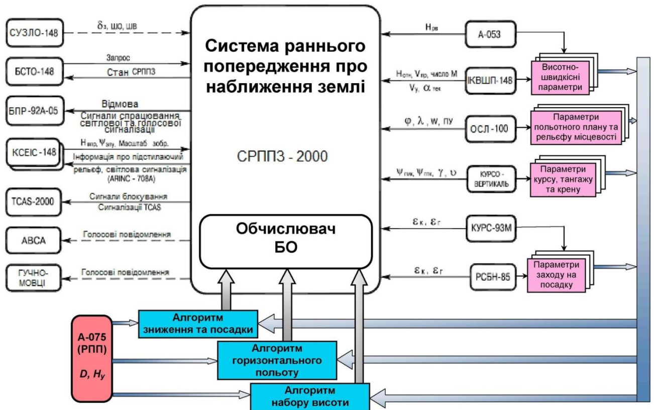
Рис. 3.14. Структурна схема удосконаленої СРППЗ з ІРВ в якості РПП на літаку АН-148
