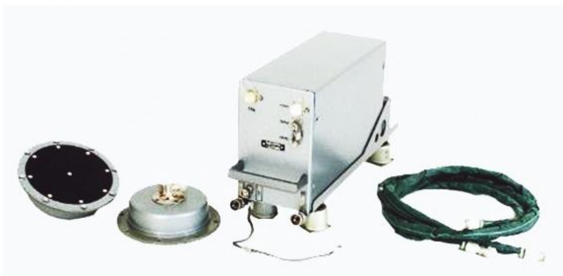
Рис. 3.11.в. Імпульсний радіовисотомір великих висот А-075 (літаків Су-27, Су-30, Су-32).
