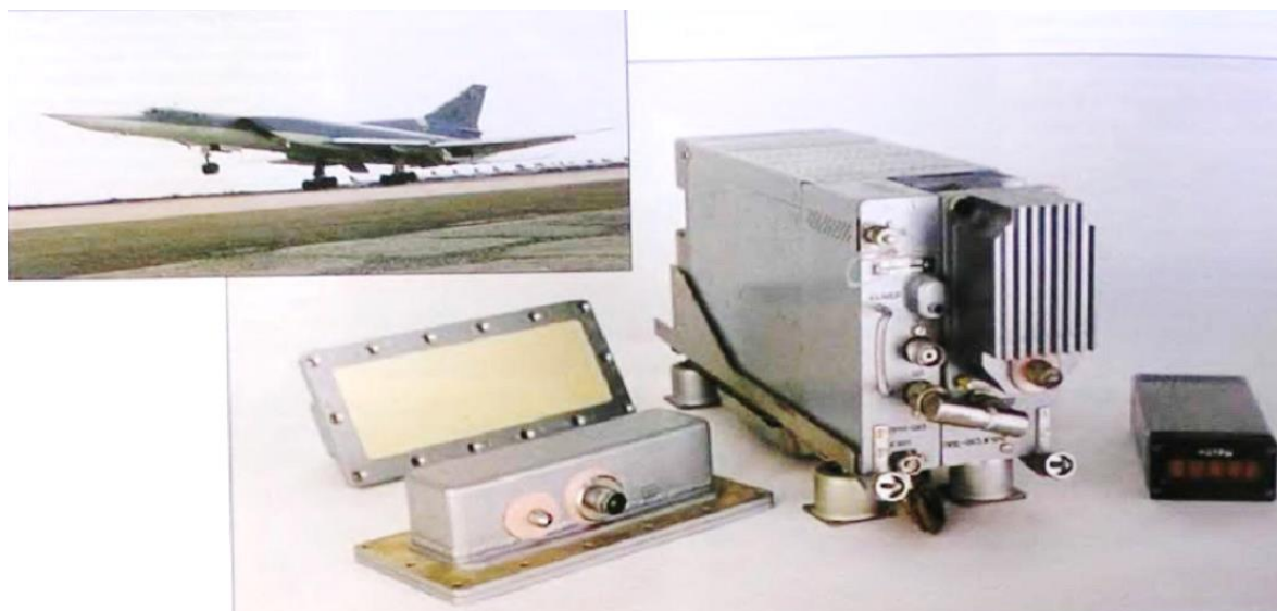
Рис. 3.11.б. Імпульсний радіовисотомір великих висот А-063 (літаків Ту-22М3, Ту-142, Ту-160).
