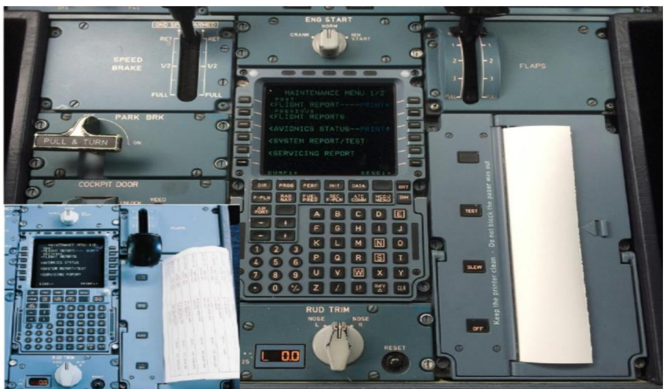
Рис.4.5. Доступ до On Board Maintenance Systems через MCDU (Master Control and Display Unit — Головна панель управління та індикації обчислювача літаководіння, тобто пульти БСТО та ВСС сполучені) літаків типу Airbus A320 и Boeing 737
