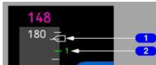
Рис. 2.13. Індикація рекомендованої швидкості при заході на посадку
