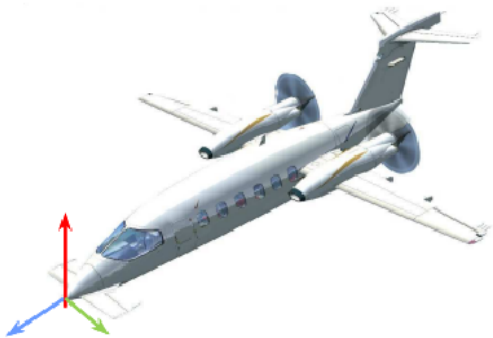
Система відліку літака V_x , V_y , V_z
