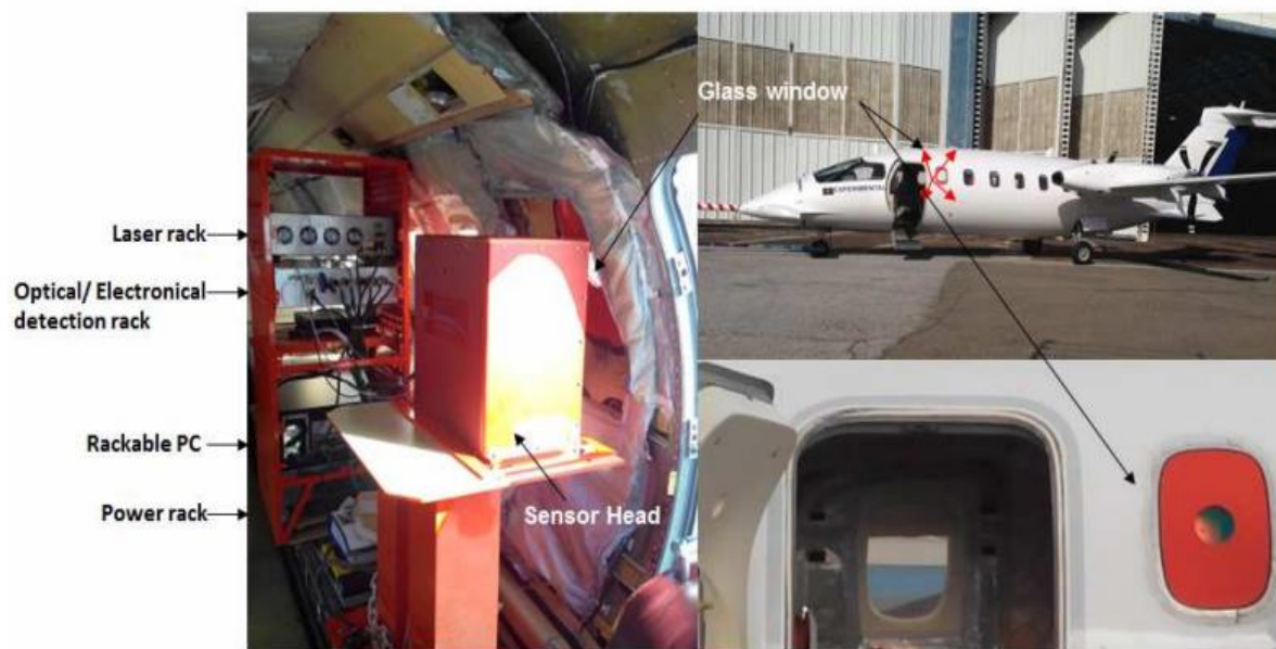
Рис 2.7 Установка лідарного анемометра на борт P180
