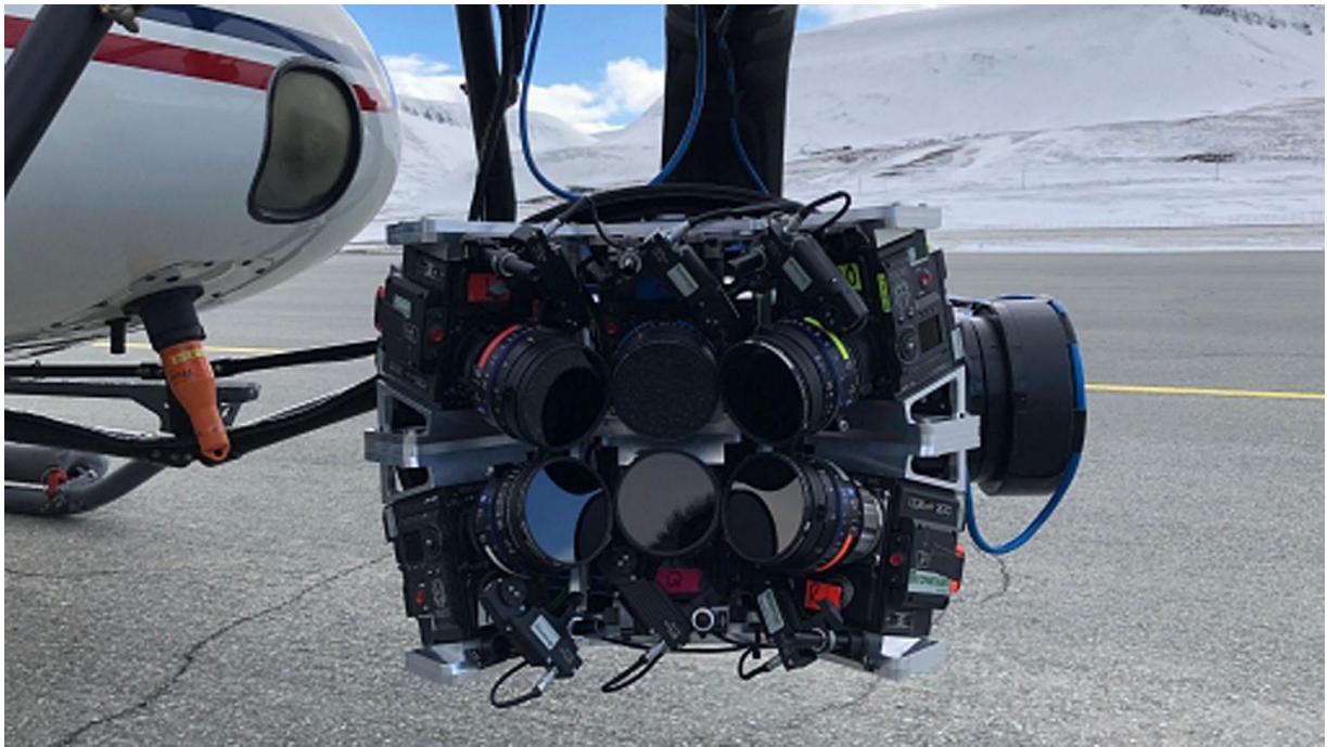
Рисунок 1.5 Кріплення камер на стабілізаторі вертольота
