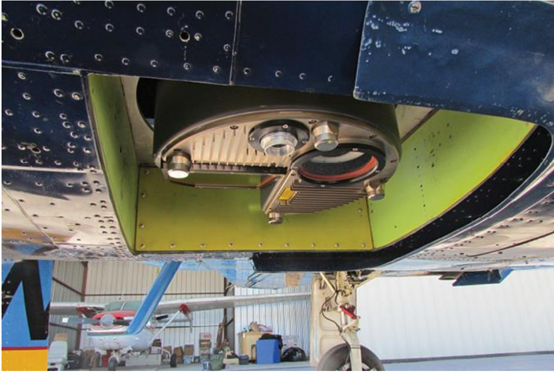
Рисунок 2.2 Мультиспектральний Ortech Titan LiDAR дискретного повернення на літаку
