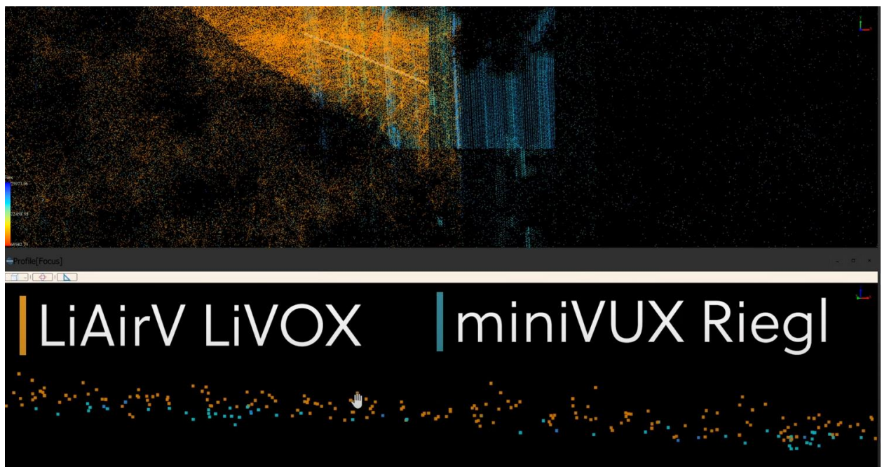
Рисунок 2.13 Порівняння розкиду LiVOX і RIEGL на твердих дорогах RIEGL має набагато щільніший шаблон розкиду середніх точок вимірювань із 3,25 см, тоді як LiVOX має 7 см. Ці вимірювання були зроблені на ділянці на твердій дорозі.
