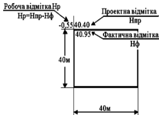
Рис. 5.11. Відмітки для вершин квадрата сітки плану вертикального планування рельєфу
