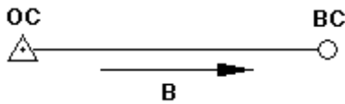
Рис. 3.11. Статичне знімання. Опорна станція (OC), координати якої відомі: X, Y, Z . Тривалість сесії – одна година. Станція, координати якої X, Y, Z визначаються (BC)
