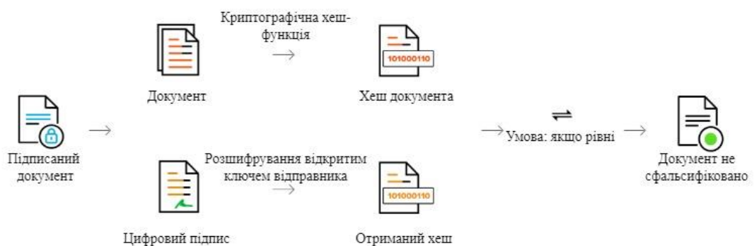
Рис. 1.4. Алгоритм перевірки документа зі сторони одержувача
