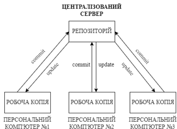
Рис. 2.3. Процес роботи системи контролю версій
