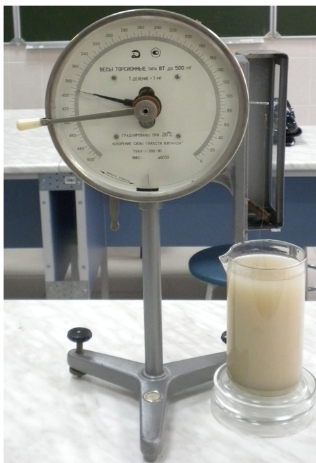
Рис. 3.5. Установка для проведення седиментаційного аналізу
