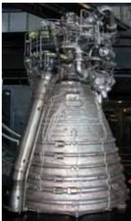
Рис. 4. Вулкан - двигун ракети Ariane 5
