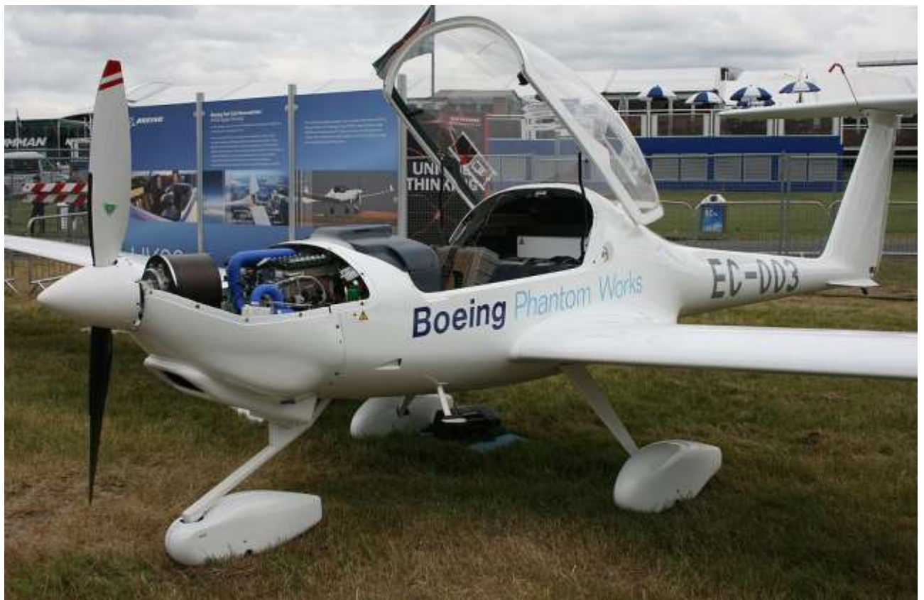
Рис. 8 Літак на водневому паливному елементі
