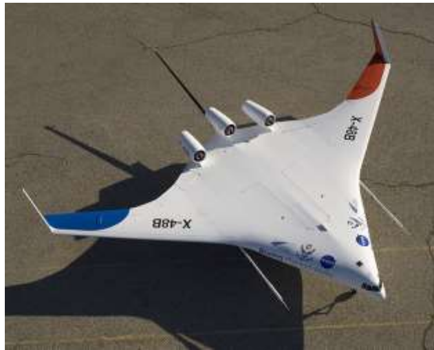
Рис.7. Літак з комбінованим фюзеляжем
