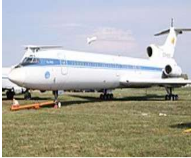
Рис.6. Прототип літака з водневим двигуном
