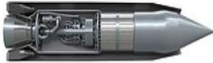
Рис.10. Синергетичний ракетний двигун з повітряним диханням
