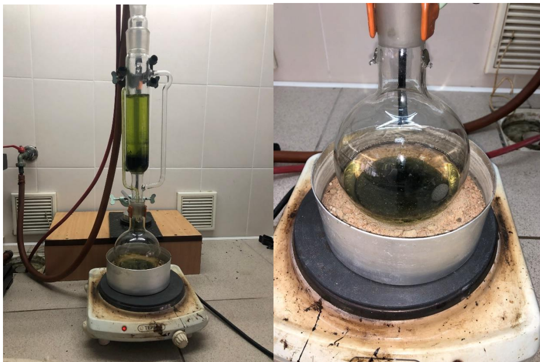
Рис. 3.9. Екстракція ліпідної фракції з водоростей роду Chlorella : а) зовнішній вигляд установки; б) кількість виділеної олії.
