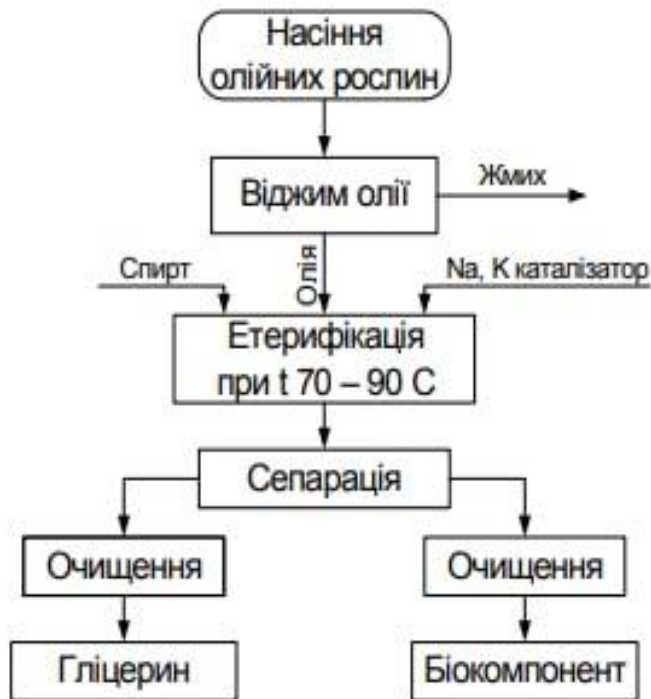
Рис. 1. Технологія виробництва біокомпоненту [18]
