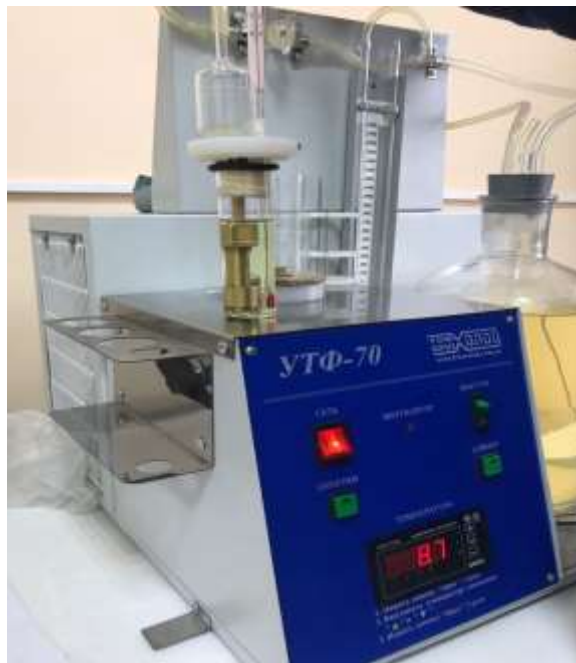
Рис.2.9. Апарат УТФ-70 для визначення ГТФ
