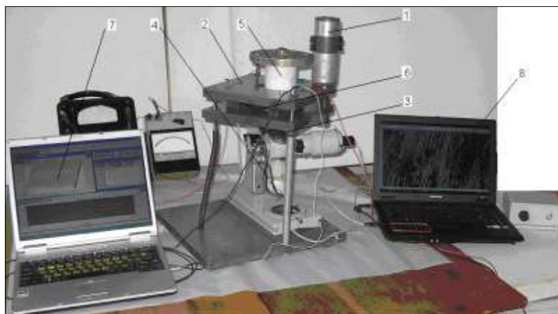
Рис.2.4 Пристрій для дослідження матеріалів на тертя та зношування
