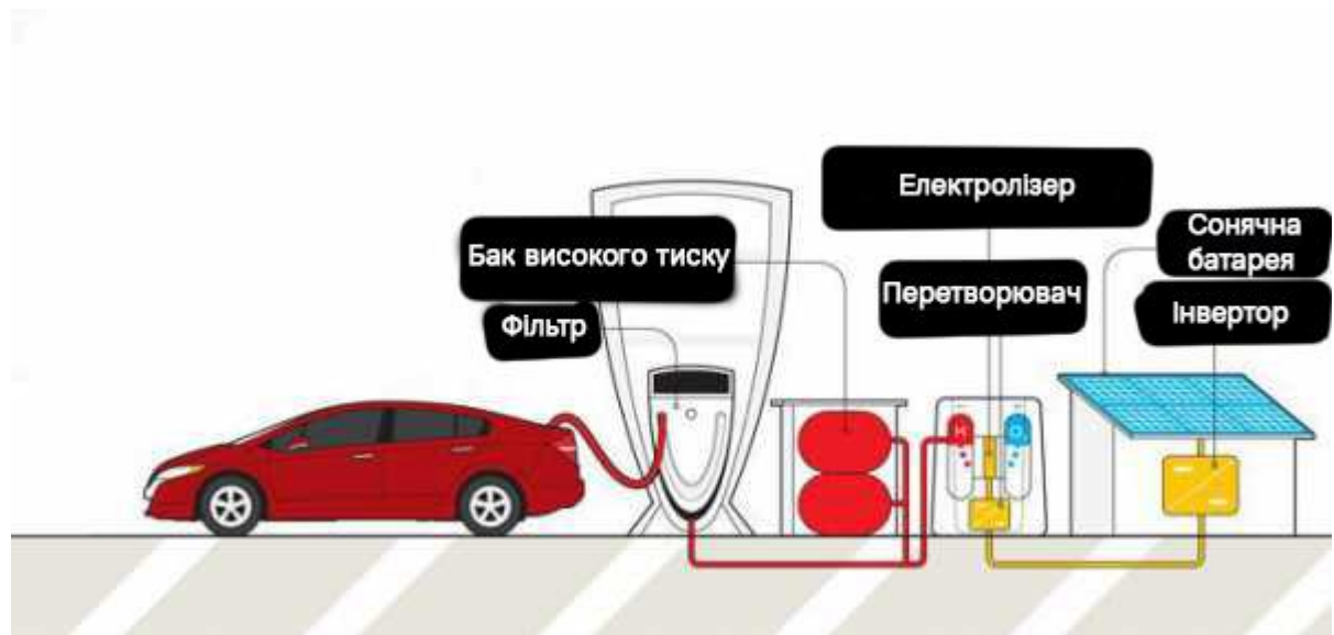
Рис. 3.3 Схема водневої заправки наземного транспорту для гібридного автомобіля
