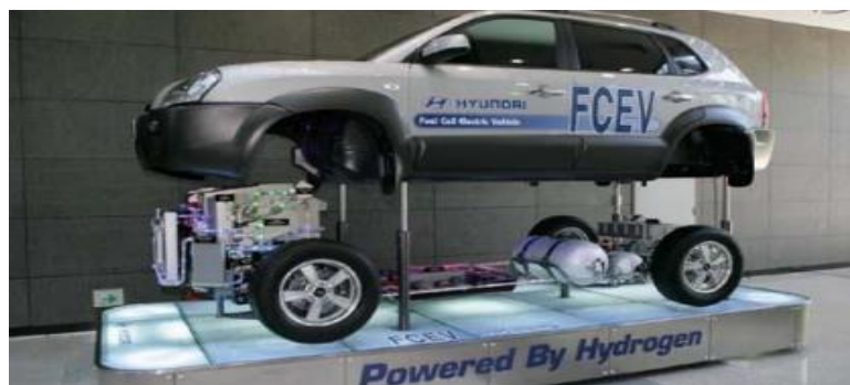
Рис.2.1. Переобладнання класичної компоновки автомобіля водневим двигуном
