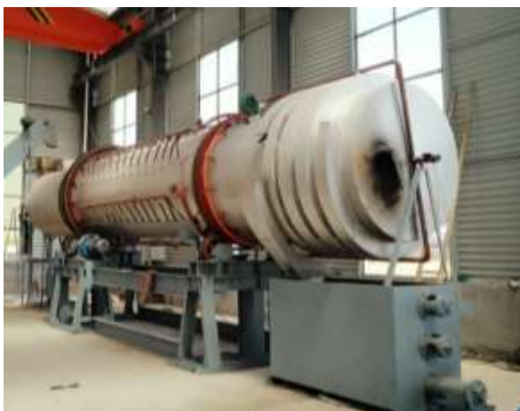
Рис. 3.3 Піч процесу активації вугілля
