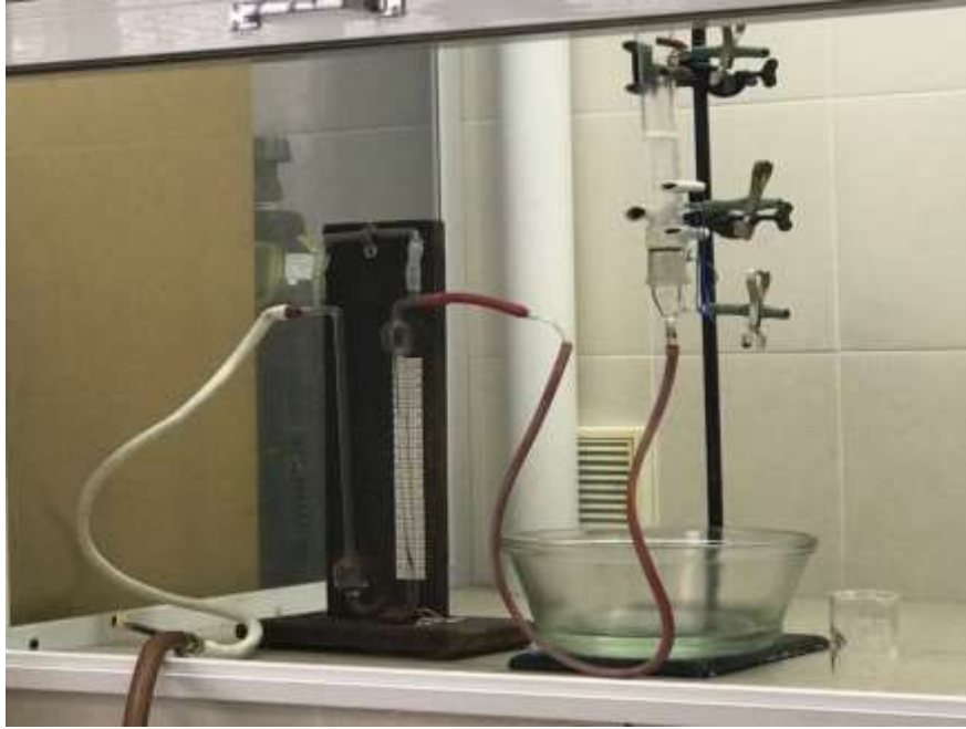
Рис. 2.2. Флотаційна установка пневматичного типу: 1 - джерело стисненого повітря; 2 - ротаметр; 3 - флотаційна колонка; 4 - пористі перегородки, що знімаються; 5 — піноприймач; 6 - склянка для збору піни; 7— затискач.
