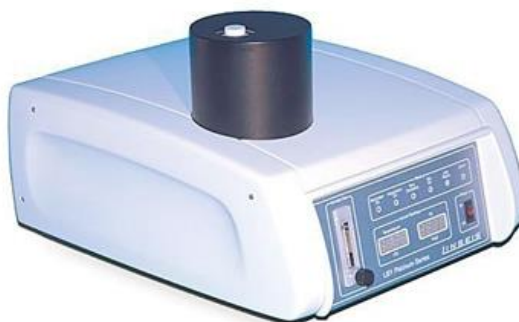
Рис. 2.2. Дериватограф Linseis STA 1000
