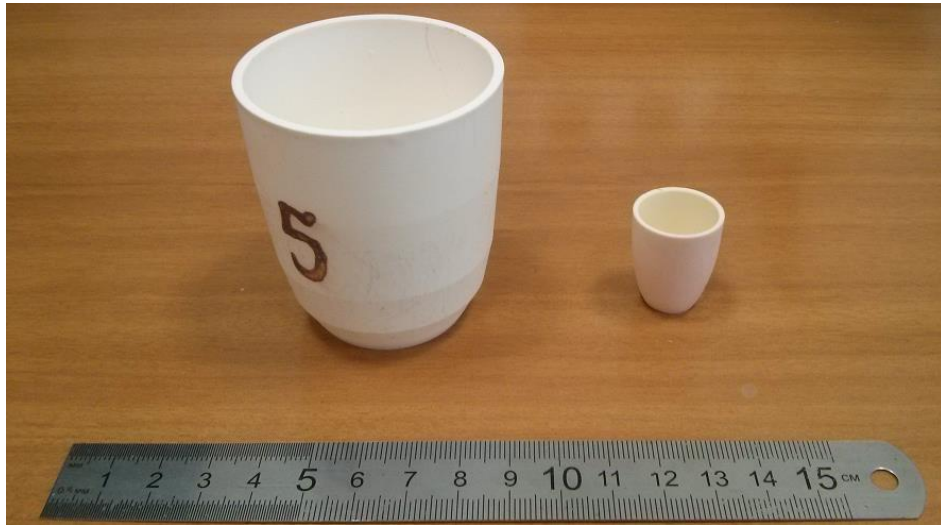
Рисунок 2.1 – Тиглі об'ємом 90 мл (ліворуч) та 4,5 мл (праворуч)
