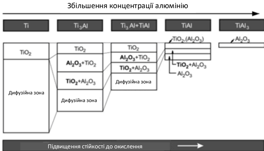
Рисунок 1.7 – Вплив співвідношення концентрації алюмінію та титану на структуру оксидного шару
