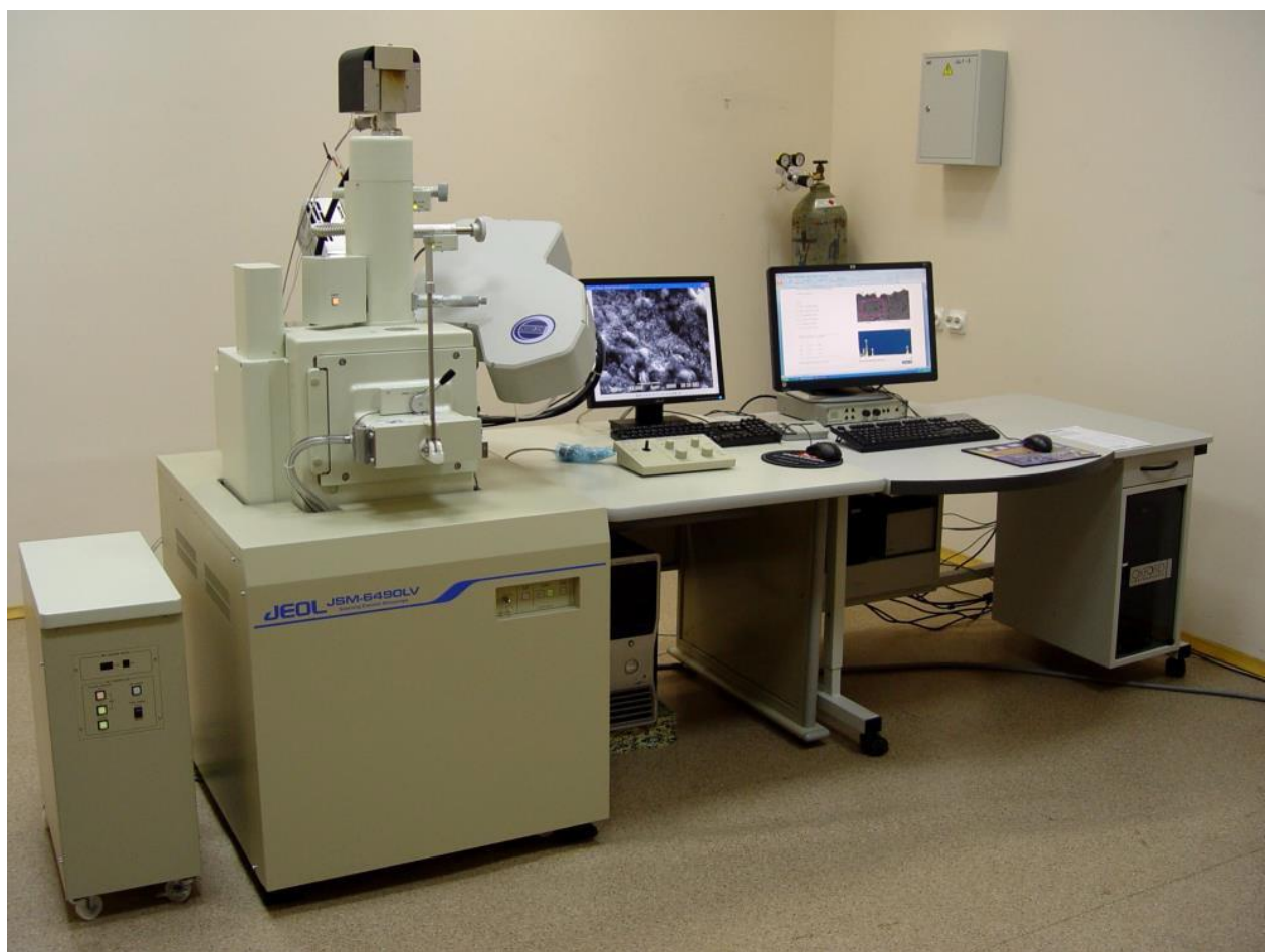
Рисунок 2.9 – Растровий електронний мікроскоп JEOL JSM-6490 LV
