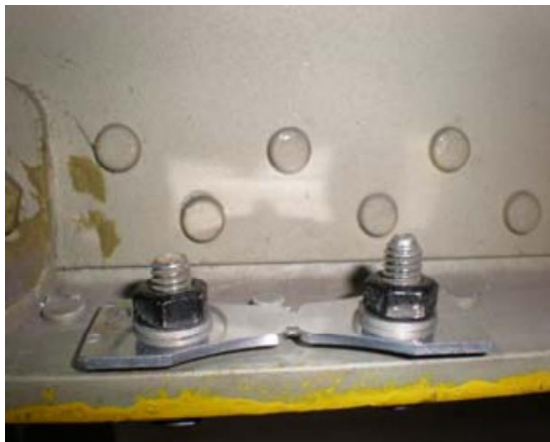
Рисунок 3.6 - Зовнішній вигляд кріплення зразка-свідка втомного пошкодження
