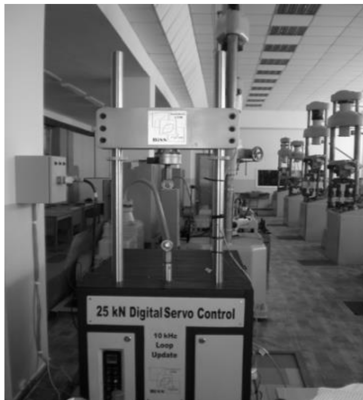
Рисунок 3.2 - Сервогідравлічна випробувальна машина у лабораторії кафедри конструкції літальних апаратів Національного авіаційного університету
