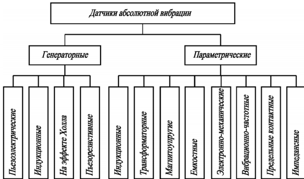
Рисунок 2.4 — Класифікація датчиків абсолютної вібрації за фізичними принципами, що використовуються для перетворення.
