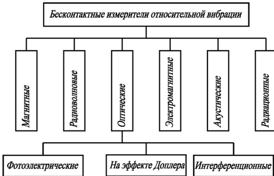
Рисунок 2.5 – Класифікація датчиків відносної вібрації відповідно з використовуваними для перетворення фізичних принципів
