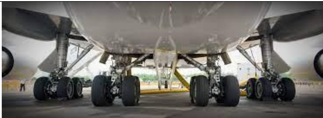
Рисунок 3.1. Розташування основних стійок шасі Boeing 747. Стійки шасі під навантаженням.
