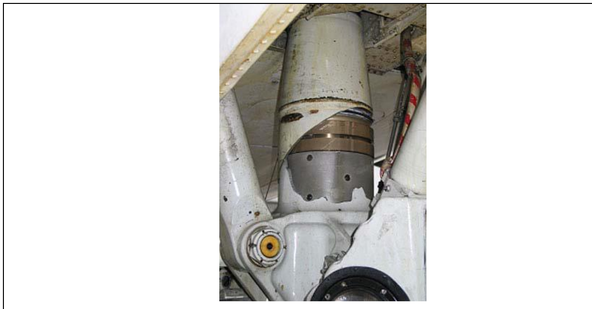
Рисунок 3.5. Зовнішній циліндр носової стійки шасі, що показує область, з якої відламана частина матеріалу циліндра
