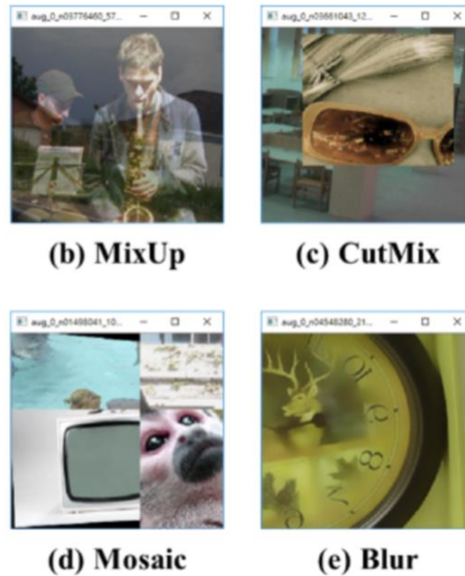
Рис. 2.12. Види аугментації для покращення роботи нейронки
