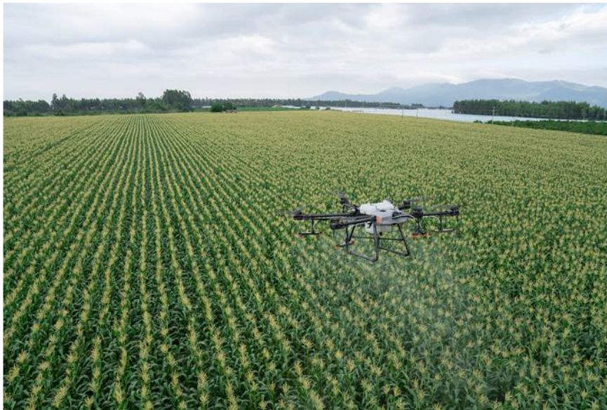
Рис. 2.11 Сільськогосподарський мультикоптер DJI Agras T30 [50]
