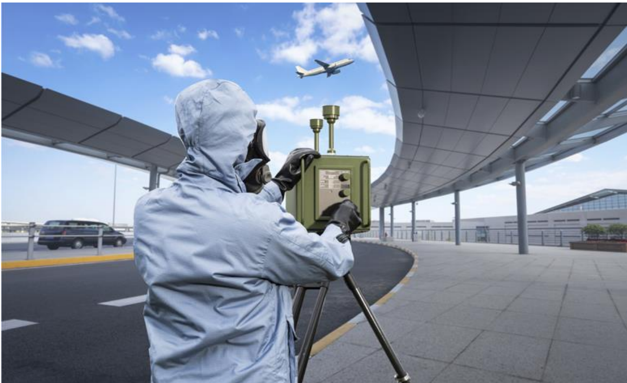
Рис.1.9. Приклад розміщення хімічного детектора
