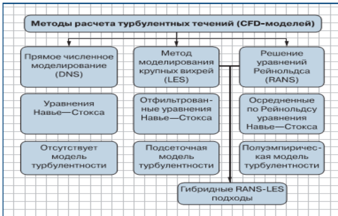
Рис. 2.1 Класифікація CFD – моделей по методам розрахунку турбулентних потоків домішок
