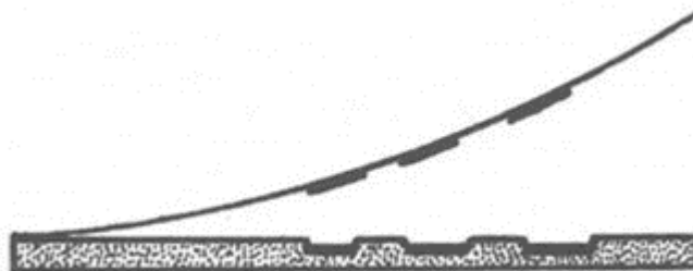
Рис. 2.2. Принцип глибокого друку
