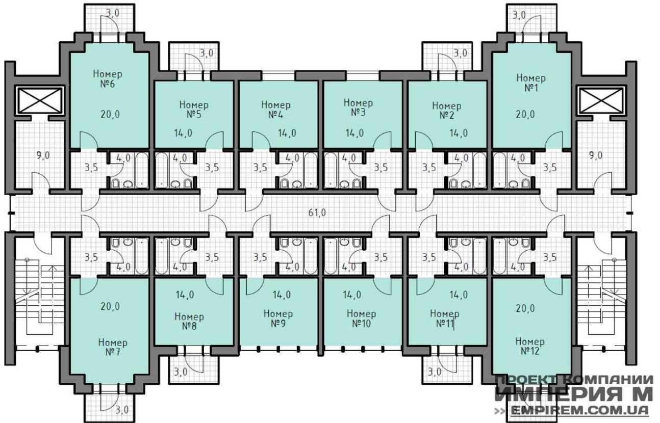
Рис 2.1.1 План типового поверху готелю
