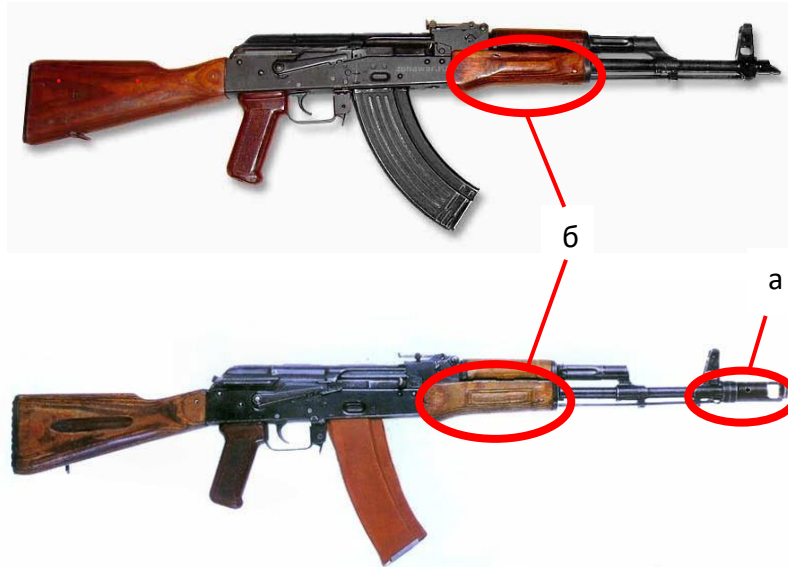
Рис.1. Зовнішній вигляд ММГ автоматів Калашникова АКМ та АК-74. а – полум'ягасник в АК74, б – нижня частина цівки
